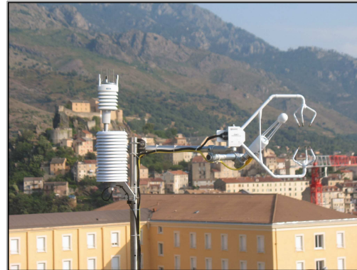
Station météo (flux chaleur, humidité, CO 2 ) Corte (juillet 2013) Labo : LA
