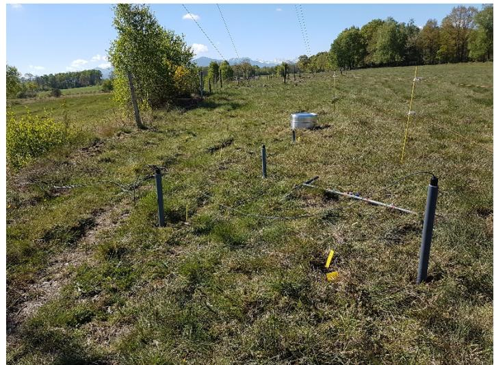
Sondes d'humidité du sol et système de mesure du flux de radon installés dans les champs alentours
