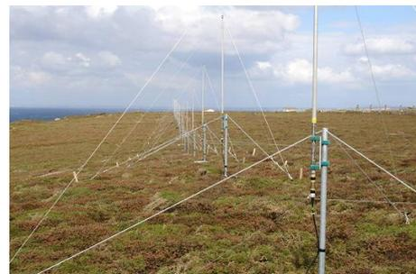
Réseaux de réception d'un radar HF
