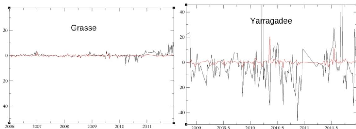
Difference en mm (apres retrait des paramètres de transfo) entre les solutions avec et sans les variations du champ NT-ATML. Pas de corrections géométriques
