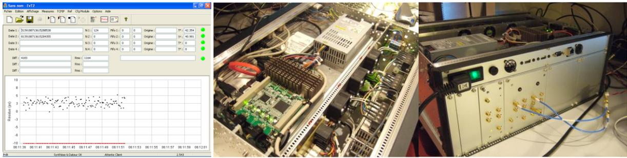
Fig 1 : Kit T2L2. De gauche à droite : face arrière avec les modules de métrologie et les entrées sorties réseaux, USB, ... ; vue de dessus avec alimentation et PC embarqué ; logiciel embarqué
