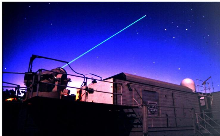
Figure 3 : La station laser SLR de l'Observatoire Géodésique de Tahiti, opérant de nuit sur un satellite altimétrique.
