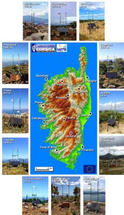
Figure 1 : Implantation des 12 stations LMA du réseau SAETTA de détection 3D temps réel des éclairs en Corse.
