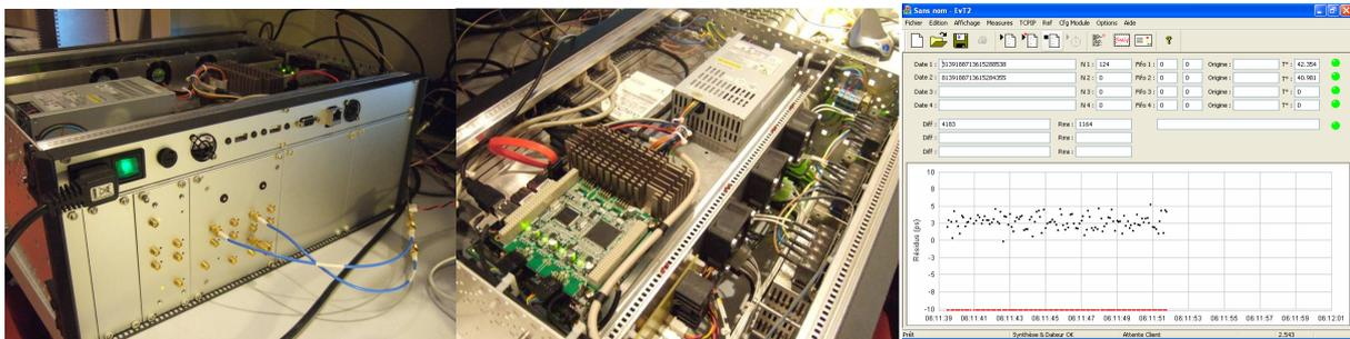
Fig 1 : Kit T2L2. De gauche à droite : face arrière avec les modules de métrologie et les entrées sorties réseaux, USB,... ; vue de dessus avec alimentation et PC embarqué ; logiciel embarqué
